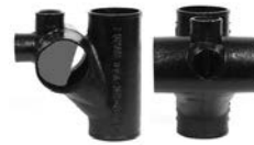
Parte No. NH 464 Cruz Para Inodoro Con Ventilación Superior de 2" y Salida Lateral de 2" (Diseñada para usarse por debajo del nivel del suelo; la Conexión tiene un deflector.)
